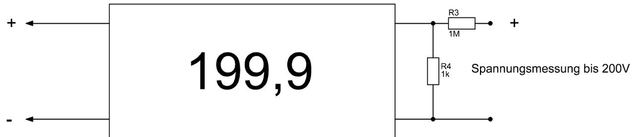
Brücke für Dezimalpunkt korrekt setzen!
